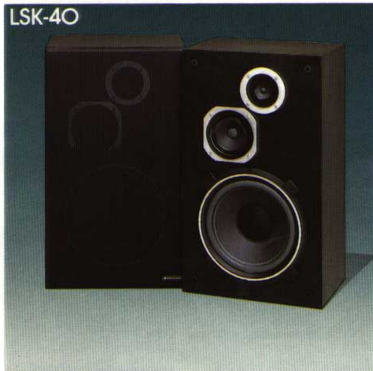
LSK-40 Luidsprekersysteem • 80 watt 3-weg, 3-luidspreker ontwerp, geheel gesloten • 25cm weergever voor de lage frekwenties • Frekwentiebereik: 40Hz—20kHz • Gevoeligheid: 89dB/W op 1 meter • LSK-400C heeft een noten afwerking • Afmetingen (b x h x d) 356 x 610 x 274mm/ Gewicht (netto) 12,0kg
