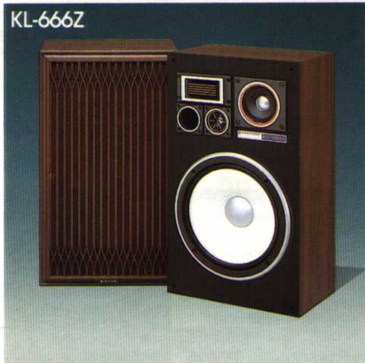
KL-666Z Luidsprekersysteem • 150 watt 4-weg 4-luidspreker bas-reflex ontwerp • 325mm conus voor de lage frekwenties, met thermische schok behandeld • Frekwentiebereik: 45Hz—20kHz • Gevoeligheid: 95dB/W op 1 meter • Afmetingen (b x h x d) 370 x 630 x 271mm/ Gewicht (netto) 13,0kg
